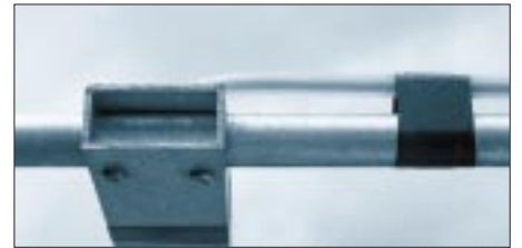
Bild 2: Befestigung der Elemente und der Phasenleitungen
